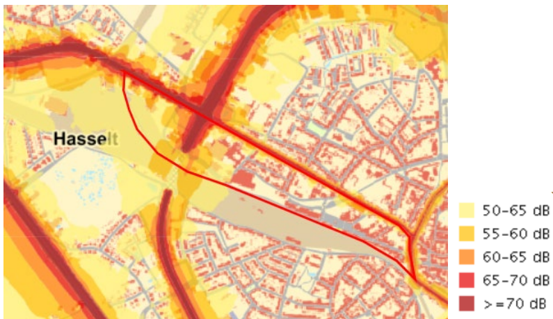
Geluidsbelasting wegverkeer Lden (Geopunt, resultaten 2016)
